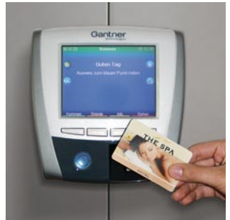
Elektronische Online-Schließsysteme mit zentralem Info-Display: Prefino integriert mühelos alle gängigen Offline- und Online-Schließlösungen. Zum Beispiel mit Fachöffnung durch Datenträger direkt am Schrank oder auch am zentralen Display, das zudem der Information über Fachbelegung und verfügbare freie Fächer dient.
